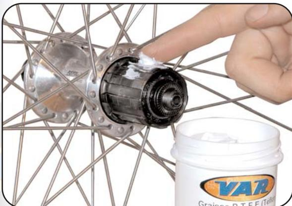
**4.** Nettoyez bien le corps de roue-libre et les pignons de la cassette. Avant le remontage de la cassette, graissez le corps de roue-libre et ses cannelures avec une graisse au Téflon®.
