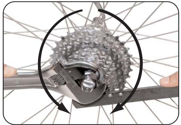
**1.** Enlever le blocage rapide puis introduisez l'outil démonte-cassette dans le contre-écrou cannelé. Repositionnez le blocage rapide afin d'éviter que l'outil ne ripec lors du démontage. Enroulez le fouet à chaîne autour d'un pignon au centre de la cassette pour qu'il soit opposé au sens de démontage. Desserrer le contre-écrou de blocage (sens inverse des aiguilles d'une montre) en maintenant la cassette à l'aide du fouet à chaîne.
