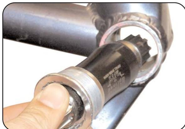
**3.** Retirez la cartouche, changez-la si les roulements accrochent. Nettoyez parfaitement le taraudage et la face d'appui de la boîte. Si vous changez de boîtier de pédalier, emportez toujours votre ancien boîtier pour comparer modèle et longueur d'axe.
