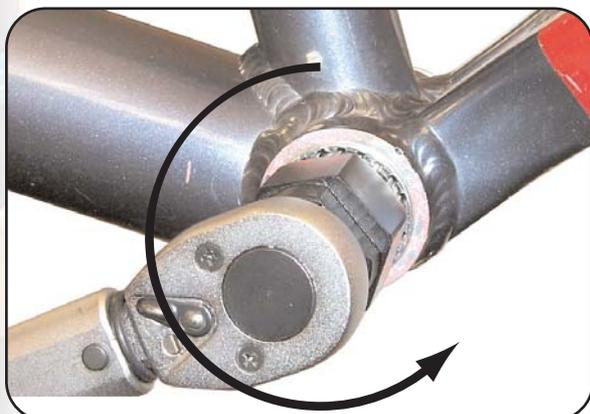
**2.** Commencez toujours par dévissez la cuvette mobile (sans rebord) et terminez par la cuvette fixe (avec rebord). Tournez dans le sens contraire des aiguilles d'une montre coté droit et coté gauche (pas inversé à droite) à l'aide d'une clé à cliquet ou d'une clé à molette.
