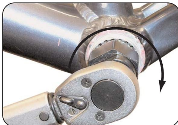
**5.** Vissez la cuvette mobile (sans rebord) jusqu'en butée sur le bloc roulement puis serrer et bloquer.
