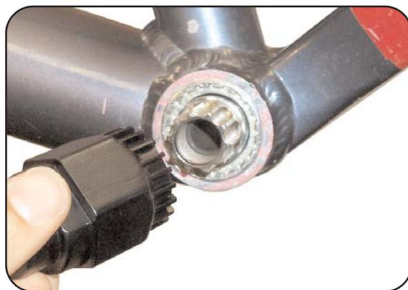
**1.** La cuvette droite des boîtiers Shimano®, FSA®, RaceFace® et Truvativ® (norme ISIS Drive®) comportent généralement un rebord d'appui sur le cadre contrairement à la gauche. Insérer l'outil dans les cannelures de la cuvette. Cet outil est compatible avec les axes à carré conique et les axes creux à cannelures.
