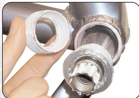
**4.** Avant le remontage, graissez le taraudage de la boîte, le filetage du boîtier et l'intérieur de la cuvette mobile. Le sens de montage du boîtier doit être respecté en repérant le coté gauche (L) du coté droit (R) inscrit sur le corps du boîtier. Introduisez le boîtier cartouche, vissez aux 2/3 la cuvette fixe. Positionnez la cuvette mobile coté opposé puis commencez à la visser. Vous pouvez bloquer la cuvette fixe à l'aide de l'outil cannelé.
