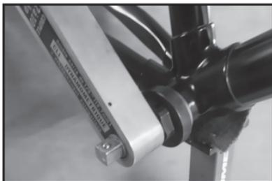
Effectuez le montage de la cuvette gauche (L) sur le cadre (filetage à droite) puis effectuez le serrage au couple préconisé (**40 - 50 Nm**) au moyen de la clé dynamométrique et de la douille de serrage.
