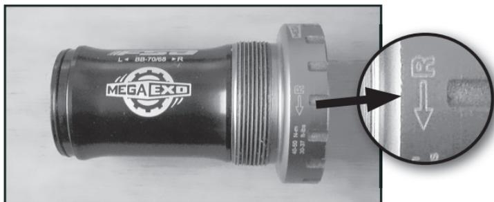
Effectuez le montage de la cuvette droite (R) sur le cadre (filetage à gauche) puis effectuez le serrage au couple préconisé (**40 - 50 Nm**) au moyen de la clé dynamométrique et de la douille de serrage.
