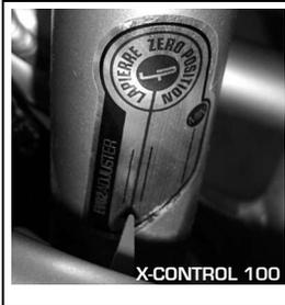
3- Réglage de SAG à l'amortisseur. (SAG: enfoncement de l'amortisseur lorsque le pilote monte sur le vélo.) En fonction des effets que vous recherchez, vous pouvez aussi jouer sur le réglage de pression de l'amortisseur pour faire varier le SAG. Si vous recherchez plus de rendement, de sensations et de maniabilité, alors optez pour un enfoncement d'environ 10-15% c'est à dire entre 4 et 6mm.
