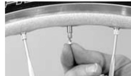
Sur les valves Presta ou Sclaverand, l'écrou moleté de la valve doit être desserré pour permettre le gonflage
