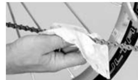
Retirez les impuretés et la graisse sur la chaîne à l'aide d'un chiffon doux
