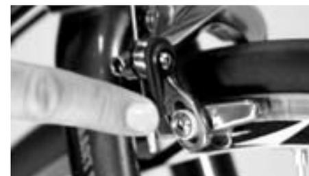
Fermeture du levier de détente sur l'étrier de frein
