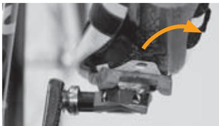
La fixation de la chaussure sur la pédale est interrompue par un mouvement de pivot du talon vers l'extérieur
