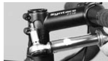
Vissez toutes les vis de serrage à l'aide d'un clé dynamométrique, en tenant compte des couples de serrage indiqués.
