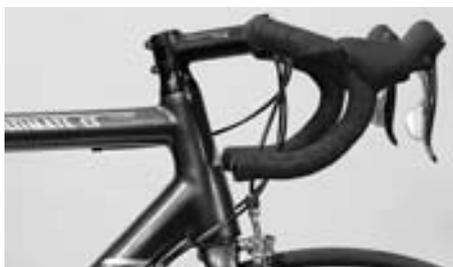
La partie basse et droite du cintre doit être parallèle au sol ou légèrement inclinée vers le bas
