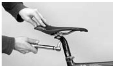
Resserrez les deux vis en alternance et progressivement, sans jamais dépasser le couple de serrage maximum requis
