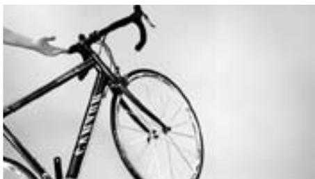
Vérifiez la souplesse de la direction en soulevant la roue avant et en déplaçant le cintre pour la faire pivoter sur son angle de braquage
