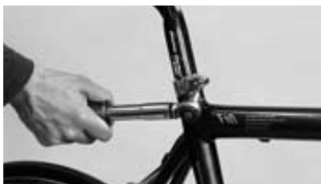
Ne serrez pas trop fort la vis du collier de serrage sur le tube de selle
