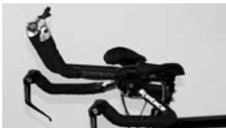
Les manettes de changement de vitesses sur le prolongateur commandent les dérailleurs avant et arrière
