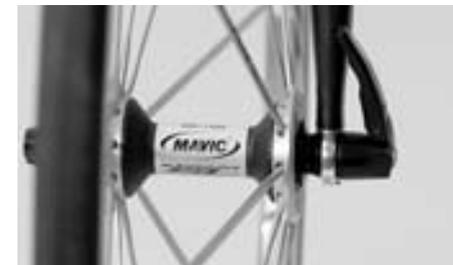
Le levier de l'attache rapide doit se trouver à peu près parallèle à la roue et ne doit pas faire saillie
