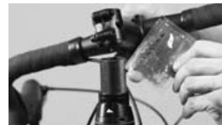
Appliquez éventuellement un peu de pâte de montage spéciale pour composants carbone sur les surfaces de contact du pivot de fourche ou du cintre avec la potence
