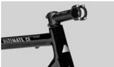
Jeu de direction monté et réglé avec potence et fourche
