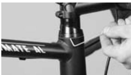
Desserrez la vis de réglage du jeu de direction
