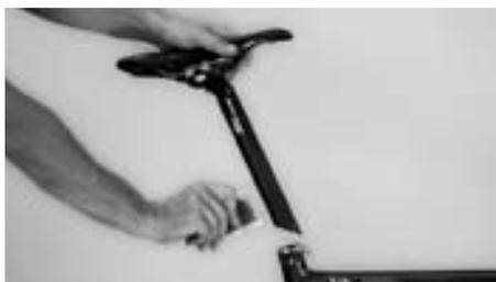
Application d'une pâte de montage pour composants carbone avant l'introduction de la tige de selle dans le tube de selle
