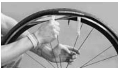
Placez le monte-pneu sous le talon du pneu et faites levier pour le faire passer par dessus le rebord de la jante
