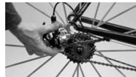
Pour démonter la roue arrière, tirez le dérailleur légèrement vers l'arrière
