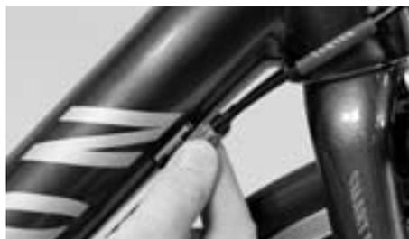
Réglage de la tension du câble sur le barillet de la butée réglable sur le cadre
