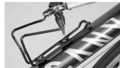
Respectez le couple de serrage maximum de 4,5 Nm pour la fixation du porte-bidon
