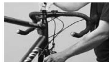
Remplacez le capuchon sur le pivot et appuyez dessus en maintenant fermement la fourche en place. Resserrez les vis de la potence, une fois celle-ci positionnée, en respectant le couple de serrage prescrit
