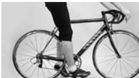
La jambe doit être complètement tendue quand la manivelle se trouve dans la position la plus basse et que le talon du pied repose à plat sur la pédale
