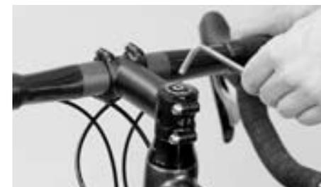
Après avoir desserré les vis de serrage de la potence sur le pivot, réglez le jeu de direction avec la vis de réglage noyée dans le capuchon
