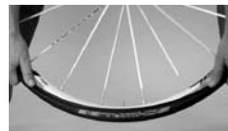
Pressez sur le pneu avec les mains pour l'introduire dans la jante
