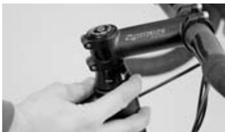
Vérifiez l'absence de jeu dans le jeu de direction en passant les doigts autour de la cuvette, puis en tirant et poussant sur le Canyon après avoir freiné la roue avant
