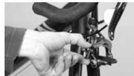
Desserrage du levier de détente pour l'ouverture du frein
