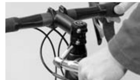
Resserrez les vis de serrage de la potence sur le pivot avec une clé dynamométrique.
