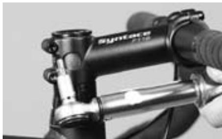
Contrôlez les vis de serrage de la potence à l'aide d'un clé dynamométrique, en tenant compte des couples de serrage indiqués
