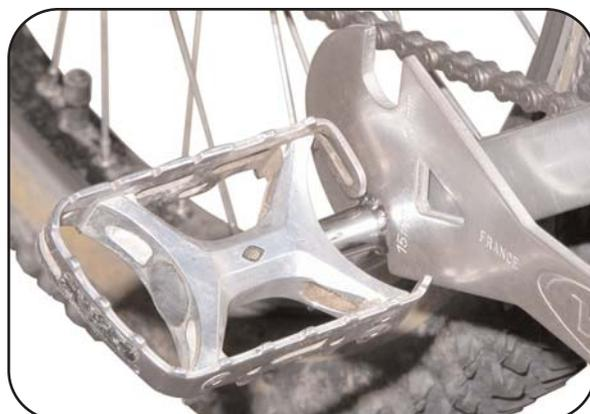
**5.** Desserrer la pédale de droite en tournant la clé dans le sens inverse des aiguilles d'une montre. Desserrer la pédale de gauche en tournant dans le sens des aiguilles d'une montre. Avant le remontage, prenez soin d'appliquer de la graisse sur l'axe fileté de vos pédales.
